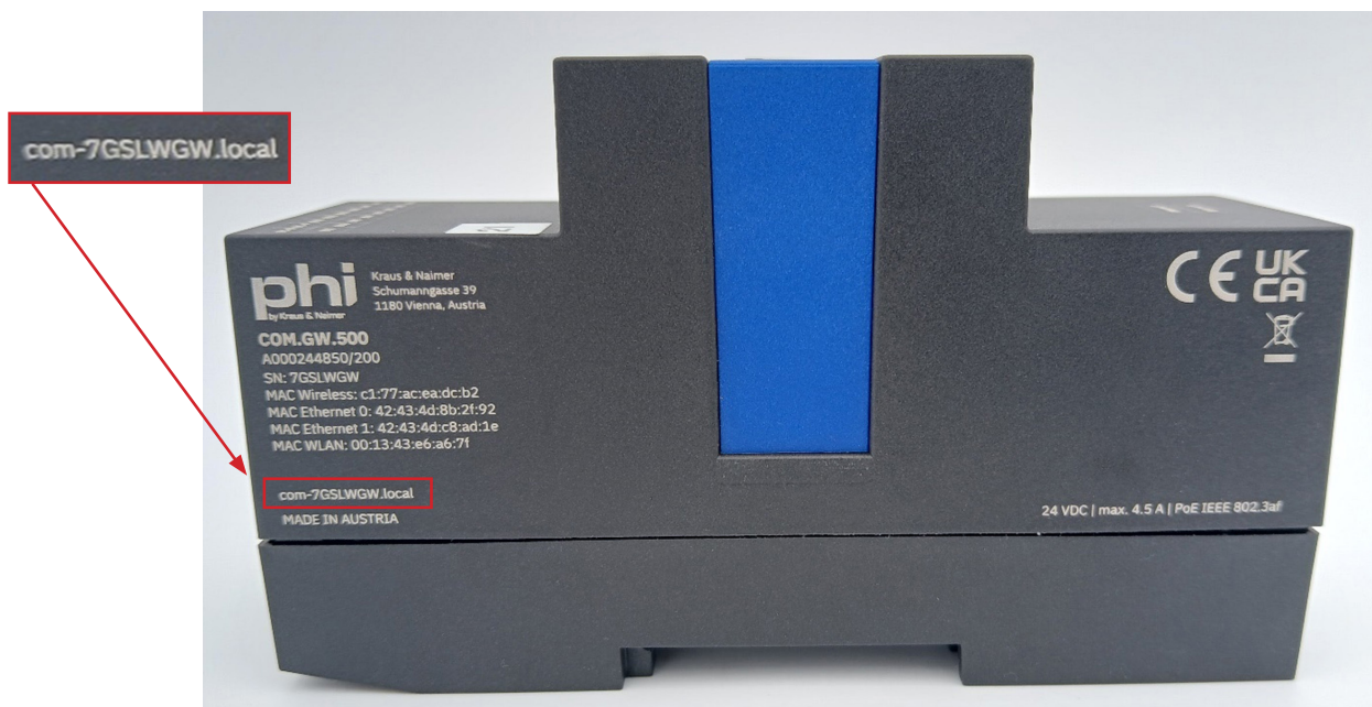
Figur 11: Markerat med rött – COM-modulens unika DNS-adress finns på enhetens vänstra sida
