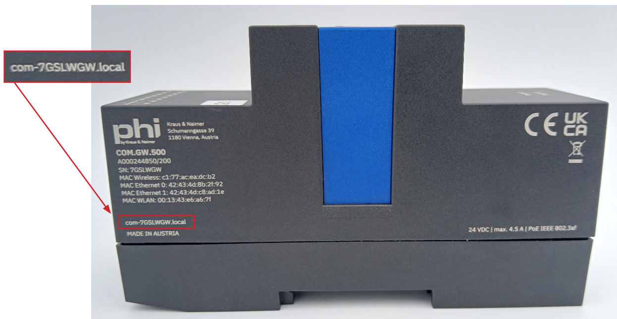
Figure 11 : Mise en évidence en rouge – l'adresse DNS unique du module COM se trouve sur le côté gauche de l'appareil
